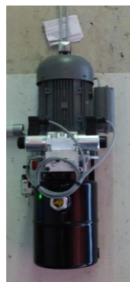
Das Bodentor bei der Schlammentwässerungsanlage wurde zur Erhöhung der Arbeitssicherheit mit einer hydraulischen Öffnung nachgerüstet.
